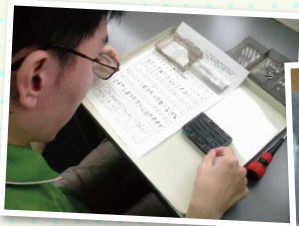
点字見本を元に刻印のピンを配置しているところ
